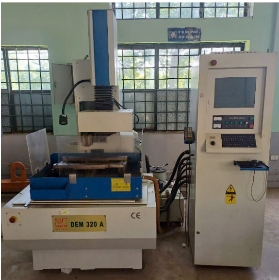
Hình 5: Máy cắt dây DEM 320A
