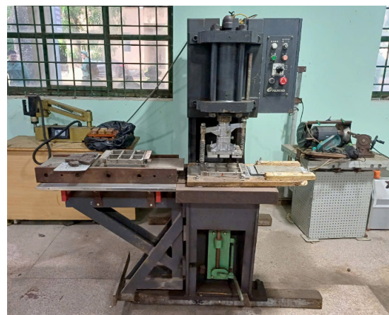
Hình 2: Máy ép thủy lực 30 tấn
