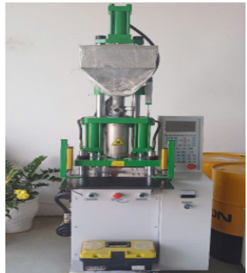
Hình 6: Máy ép khuôn nhựa 25 tấn
