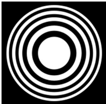
Hình 1. Cấu trúc tấm đối Fresnel
