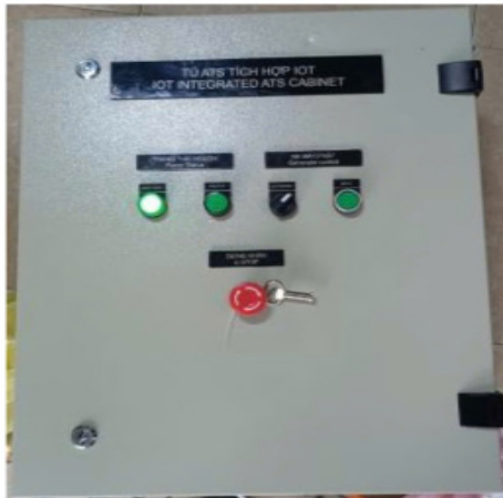
Hình 2.4. Chế tạo lắp ráp phần cứng cho mô hình thực hành IoT trên tủ ATS.
