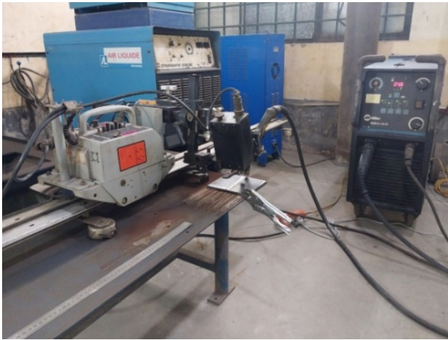
Hình 2.1. Máy hàn Mig Matic 300DX và xe tự hành
