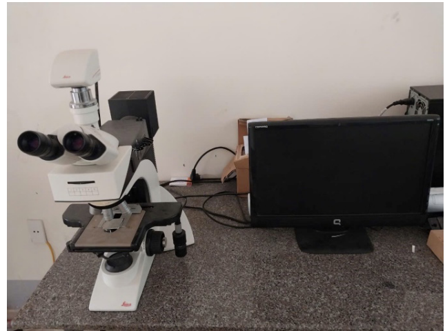
Hình 2.2. Kính hiển vi quang học leica
